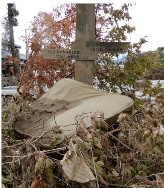
写真 3 妙笑寺に建立されている洪水位を示す標柱
